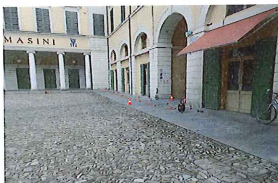
Foto 9,10,11 - Esecuzione di prova sismica ESAC (n° 2) : stendimento geofonico e acquisizione dati.
