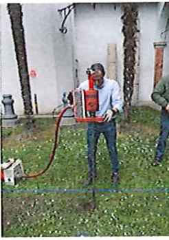
Foto 6 - Preforo e rivestimento (foro DP2). Foto 7 - Prova DP2. Foto 8 - Verifica piezometrica in DP2.
