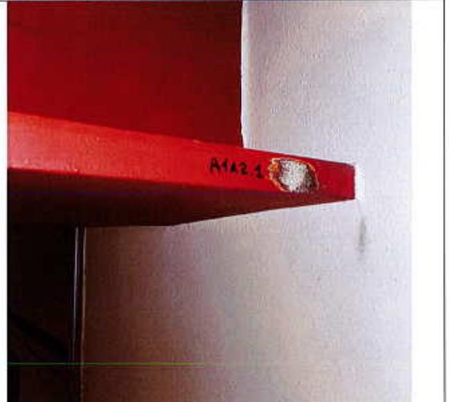
Le durezze A1-A-2.1 e A1-A-2.2 sono state effettuate sull'ala inferiore della trave
