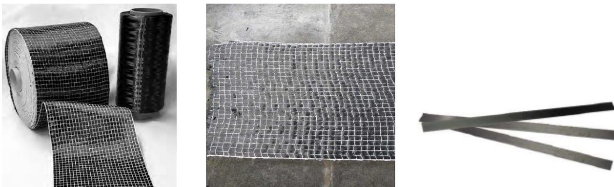
Fig. 7 - Tessuti e Lamelle pultruse in fibra di carbonio
